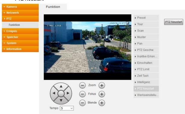
Die Kamera startet die Funktionen des Menüs PTZ neu und führt einen Schwenktest durch. Die im PTZ Menü gespeicherten Einstellungen bleiben nach dem Neustart erhalten.
