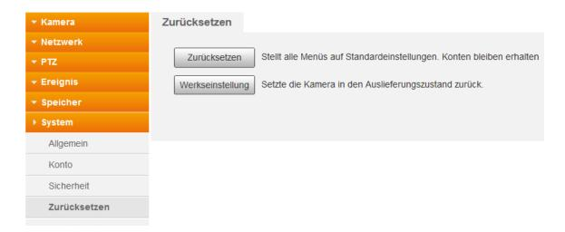
*Hinweis*: Die Kamera kann auch auf Werkseinstellung zurückgesetzt werden, indem Sie den Reset-Button neben dem SD-Slot für ca. 15 Sekunden lang gedrückt halten. Den SD-Slot bzw. den Reset Button finden Sie nach entfernen der beiden Schrauben und dem Gehäusedeckel (auf der gegenüberliegenden Seite des Objektives).
