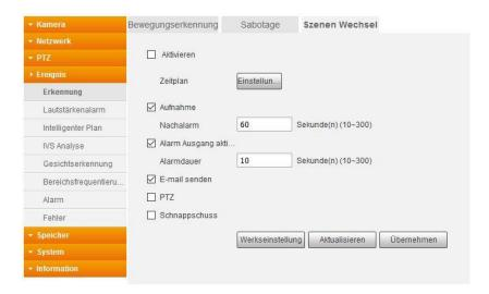
Das Prinzip der Geräuscherkennung, ist der Bewegungserkennung gleich. Wird ein Geräusch erkannt löst dieses eine "Aktion" aus. An die Kamera muss dazu ein externes Mikrofon angeschlossen werden.
