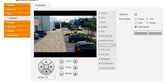
In diesem Menü können Sie festlegen welche Funktion ausgeführt werden soll wenn die Kamera neu gestartet wird. Voraussetzung ist, dass die ausgewählte Option bereits konfiguriert wurde.
