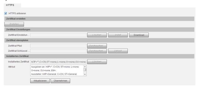
In diesem Menü können Sie das selbst signierte SSL-Zertifikat der Kamera löschen und theoretisch ein neu signiertes (und kostenpflichtiges) Zertifikat hinterlegen. Das hinterlegte Zertifikat reicht für den Zugriff aus, allerdings erhält man beim https- Zugriff eine Warnmeldung, dass es sich um keine sichere Verbindung (da nicht offiziell Signiert) handelt.
