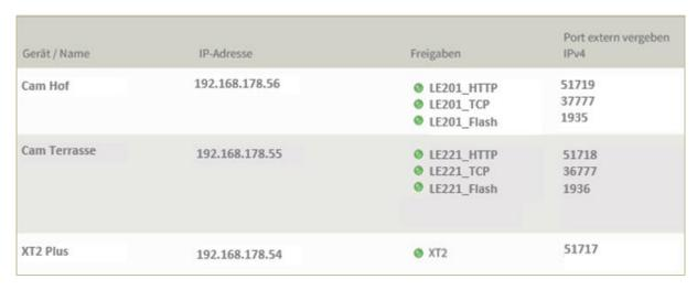
Hinweis: Damit Sie aus der Ferne auf das richtige Gerät geleitet werden, darf der externe Port nur einmal vergeben werden! Benötigen Sie Portweiterleitungen für mehrere Kameras, müssen Sie unter Netzwerk → Port den jeweiligen Standard-Port in der Kamera abändern.
